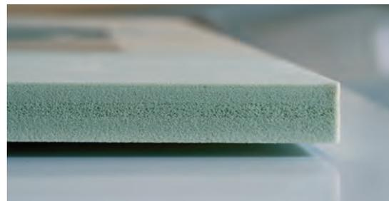
PET-Dämmstoff aus recycelten PET-Flaschen
